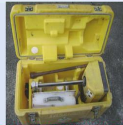
วัดสำรวจความชื้นและความหนาแน่น Am-241 /Be, Cs-137
