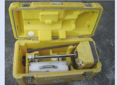
วัดสำรวจความชื้นและความหนาแน่น Am-241 /Be, Cs-137
