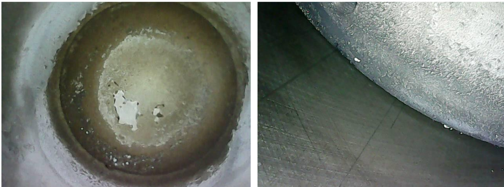
รูปที่ 2-5 ตัวอย่างความเสียหาย เนื่องจาก H_2S และความชื้นในก๊าซชีวภาพ
