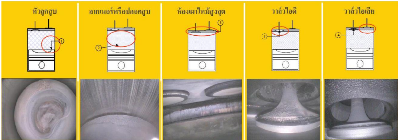
รูปที่ 2-6 ตำแหน่งการส่ง Video Check เพื่อตรวจสอบสภาพภายในเครื่องยนต์
