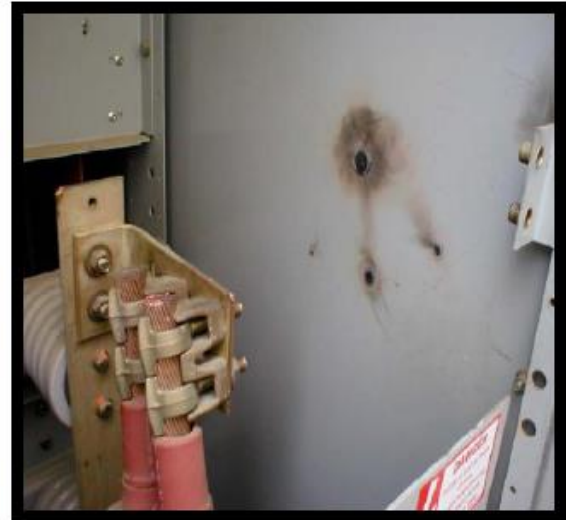
รูปที่ 2 รังสีความร้อน แสงจ้า และโลหะหลอมละลายที่เกิดจากอาร์ก
