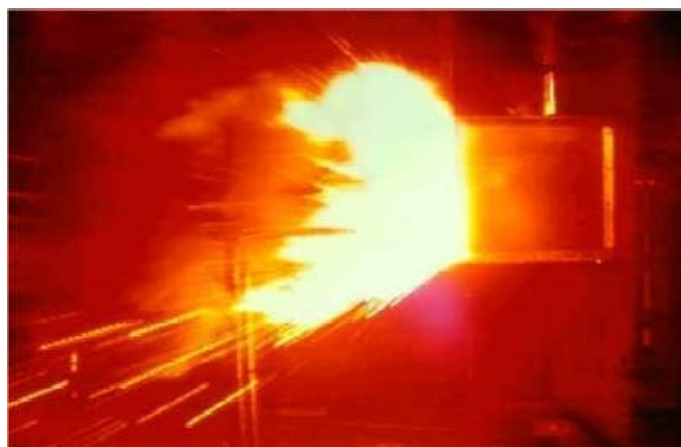
รูปที่ 1 การระเบิดจากอาร์ก (Arc Blasting)
