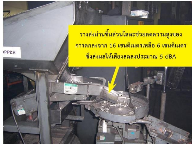
แก้ไขด้วยการติดตั้งรางส่งผ่าน : 88 dBA ที่ 1 เมตร
