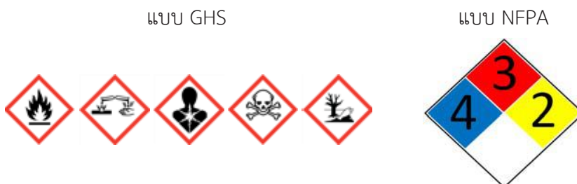
รูปที่ 3-5 สัญลักษณ์เตือนความเป็นอันตรายที่ถังเก็บ
