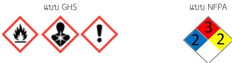
รูปที่ 3-5 สัญลักษณ์เตือนความเป็นอันตรายที่ถังเก็บ
