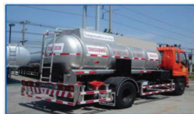
รูปที่ 4-5 ป้ายและสัญลักษณ์บนรถแท็งก์ยัดติดถาวรกับตัวรถขนส่งเอทิลีนไดคลอไรด์
