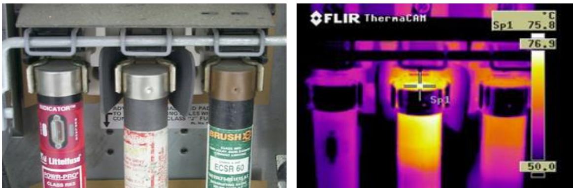
รูปที่ 4.3 ตัวอย่างการตรวจสอบขั้วต่อหรือจุดต่อสาย โดยการใช้กล้องอินฟราเรดตรวจวัดความร้อน
