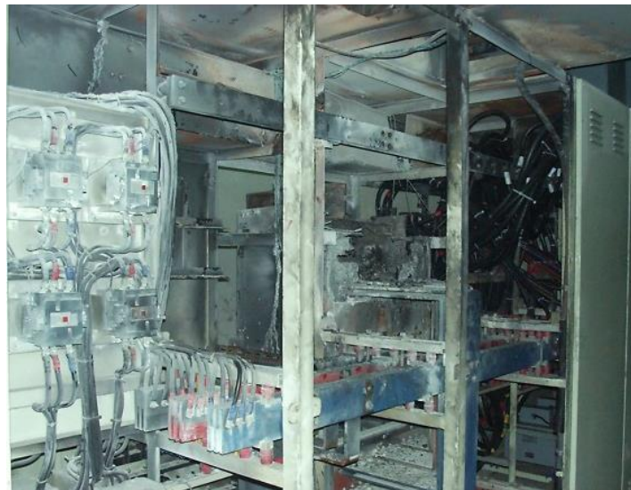
รูปที่ 1.83 ตัวอย่างความเสียหายจากการระเบิดจากอาร์ก
