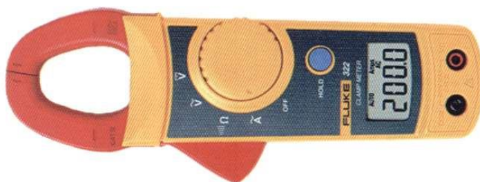
รูปที่ 1.19 ตัวอย่างเครื่องวัดชนิดคล้องสาย
