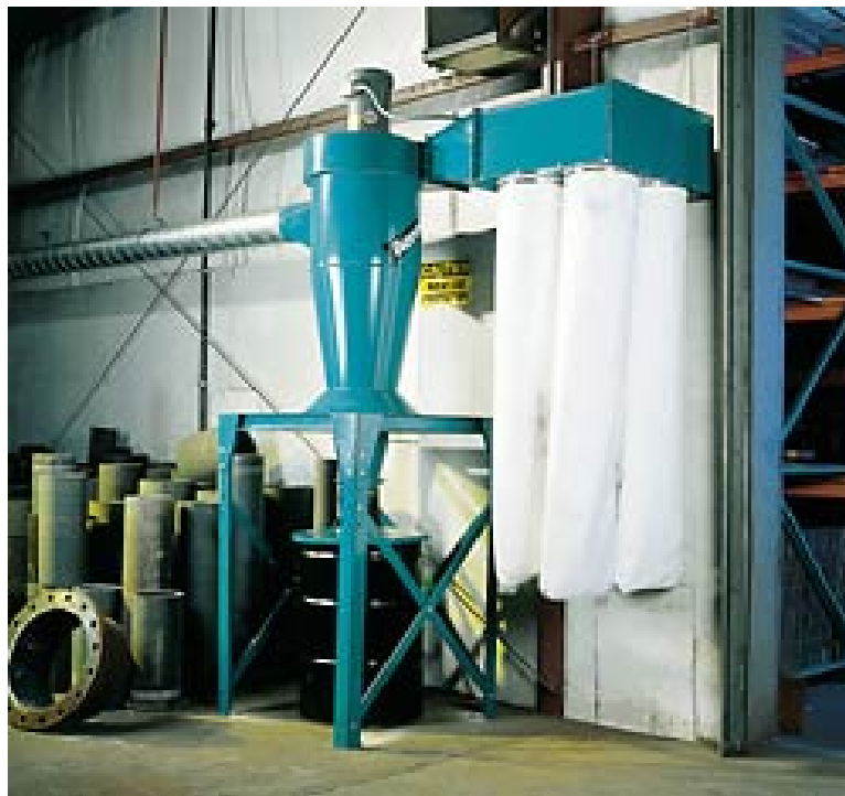
รูปที่ 2-11 แสดงระบบการเก็บฝุ่นด้วย Cyclone Dust Collector และ Bag Filter
