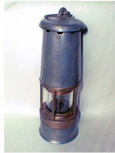
รูปที่ 1-4 แสดงการเกิดระเบิดในเหมืองถ่านหิน และตะเกียงแบบป้องกันการระเบิด
