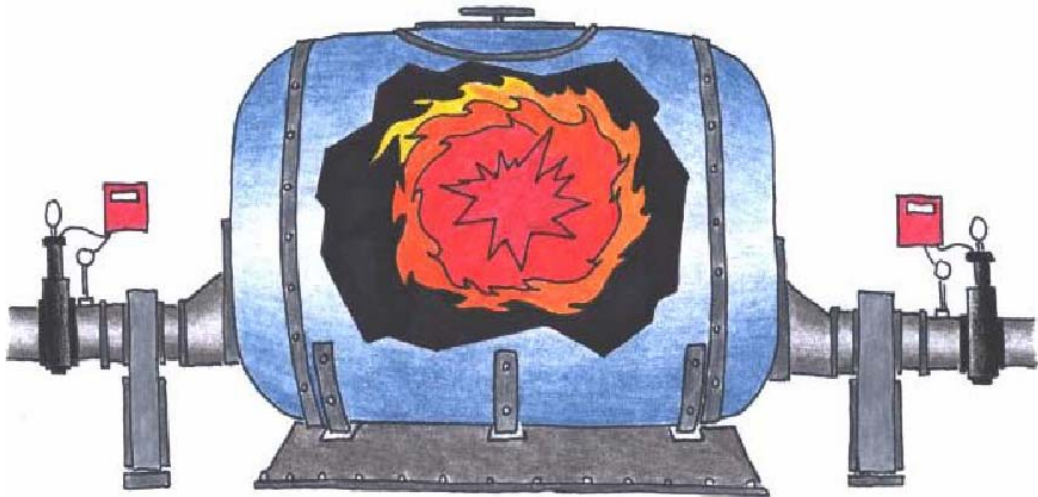
รูปที่ 10-8 แสดงการติดตั้งวาล์วปิดกั้นเปลวไฟเมื่อเกิดการระเบิด โดยโครงสร้างของถังจะต้องทนแรงระเบิดได้
