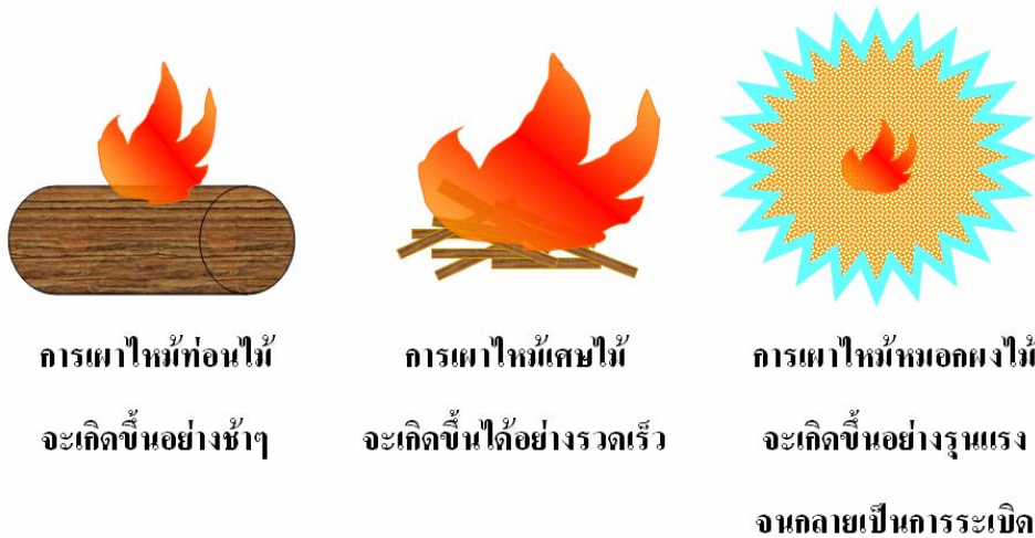
รูปที่ 2-1 แสดงอัตราเร็วหรือความรุนแรงของการเผาไหม้เมื่อเพิ่มผิวสัมผัสของเชื้อเพลิงกับอากาศ
