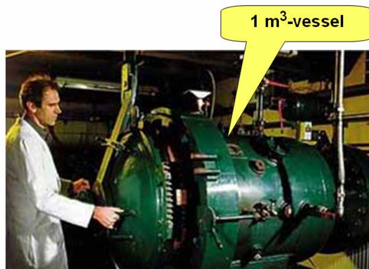
รูปที่ 2-3 แสดงตัวอย่างการทดสอบแรงอัดอากาศจากการระเบิดภายในถังขนาด 1 ลูกบาศก์เมตร
