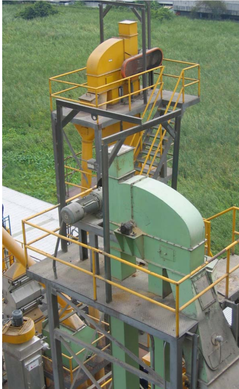
รูปที่ 2-8 แสดงเครื่องขนถ่าย (Bucket Elevator) เมล็ดพันธุ์พืชในแนวตั้ง
