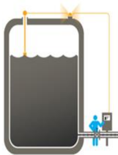
แบบที่ 2 ระบบที่มีสัญญาณเตือนให้ผู้ปฏิบัติงานทราบและดำเนินการปิดระบบการรับสารเคมีได้ตามเวลาที่กำหนดก่อนมีการล้น
