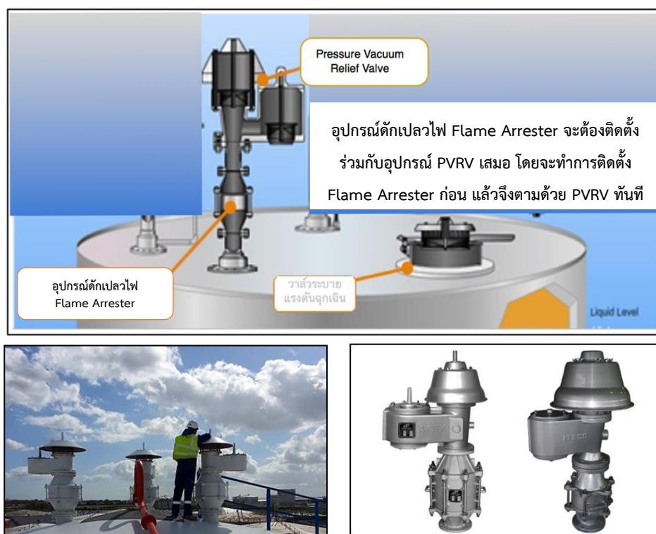
รูปที่ 2.26 การติดตั้งอุปกรณ์ดักเปลวไฟร่วมกับวาล์วระบายความดัน
