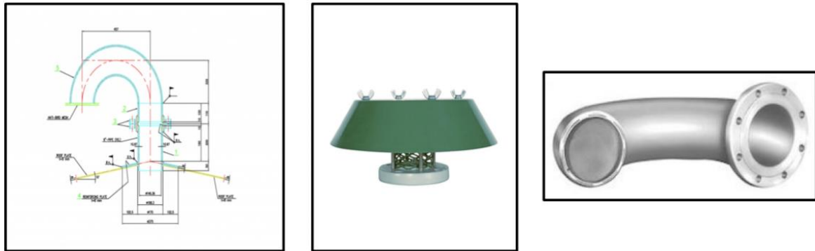
รูปที่ 2.23 ลักษณะของวาล์วระบายความดันแบบปล่อยอิสระ (Free Vent)
