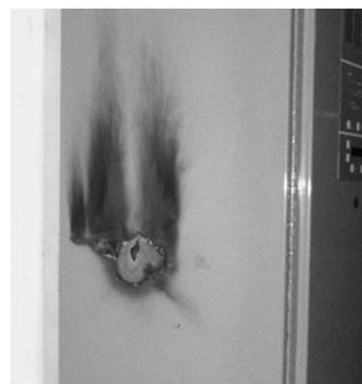
ไฟฟ้าลัดวงจร : โลหะละลาย-ทะลุ
