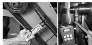
การใช้เครื่องมือวัดความดังของสายพาน
