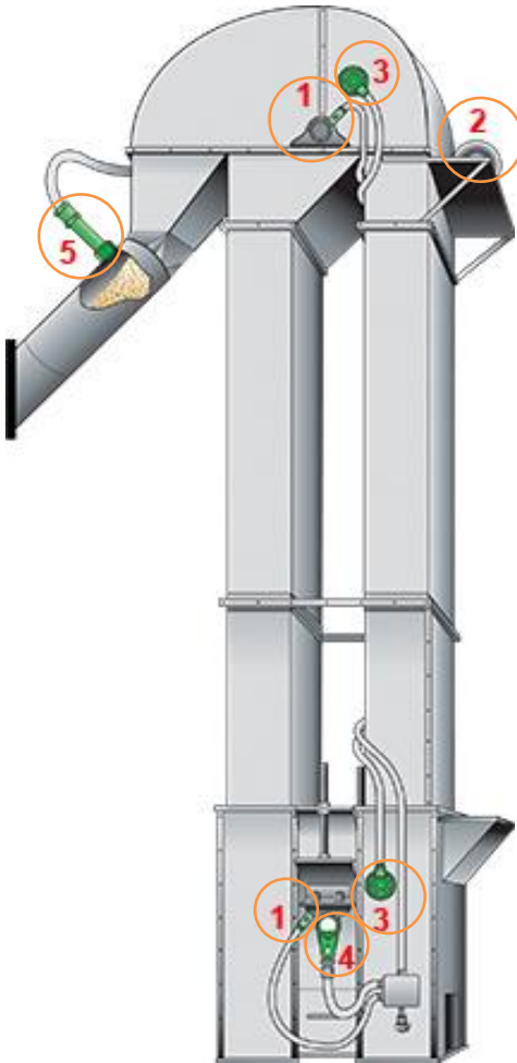
รูปที่ 6 จุดติดตั้งเซ็นเซอร์
