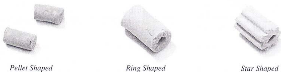
รูปที่ 1-4 ตัวอย่างรูปแบบตัวเร่งปฏิกิริยาที่ใช้ในกระบวนการผลิตกรดซัลฟิวริก
