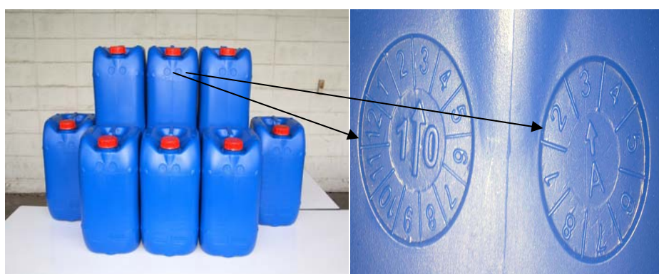
รูปที่ 3-9 เครื่องหมายแสดงเดือน ปี และกะที่ผลิตบรรจุภัณฑ์ชนิดถังทรงหลายเหลี่ยม
