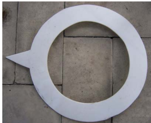
รูปที่ 5-3 ปะเก็นเทฟลอนที่ใช้ระหว่างหน้าแปลนท่อในการขนถ่ายกรดซัลฟิวริก
