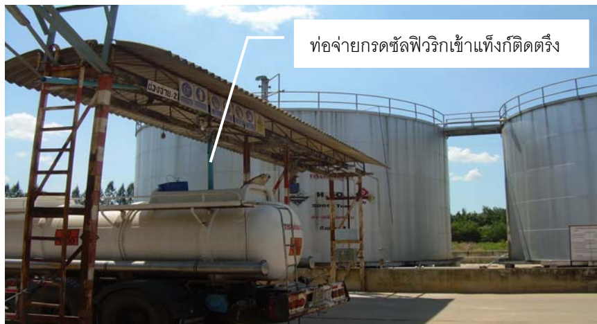
รูปที่ 5-11 การขนถ่ายกรดซัลฟิวริกจากถังเก็บลงสู่แท็งก์ติดตริง
