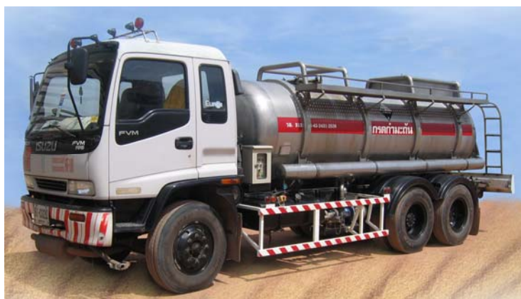
รูปที่ 3-12 รถขนส่งกรดซัลฟิวริกชนิดแท็งก์ที่ยึดติดกับตัวรถหรือแท็งก์ติดตึ๊ง ตามรหัส L4BN
