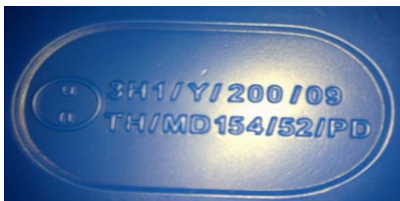
รูปที่ 3-10 เครื่องหมายสหประชาชาติของถังทรงหลายเหลี่ยมที่ใช้บรรจุกรดซัลฟิวริก
