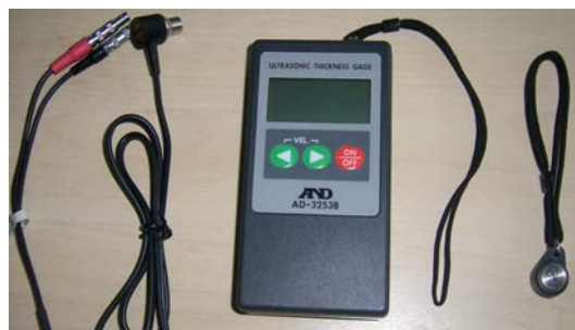
รูปที่ 3-8 เครื่องมือวัดความหนาด้วยคลื่นเสียงชนิดอัลตราโซนิก
