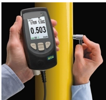
รูปที่ 8.1 ตัวอย่างเครื่องมือวัดความหนาด้วยคลื่นเสียงชนิดอัลตราโซนิก
