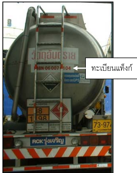
รูปที่ 4-2 แสดงตำแหน่งทะเบียนแท็งก์อยู่ด้านหลังของแท็งก์ติดตริง
