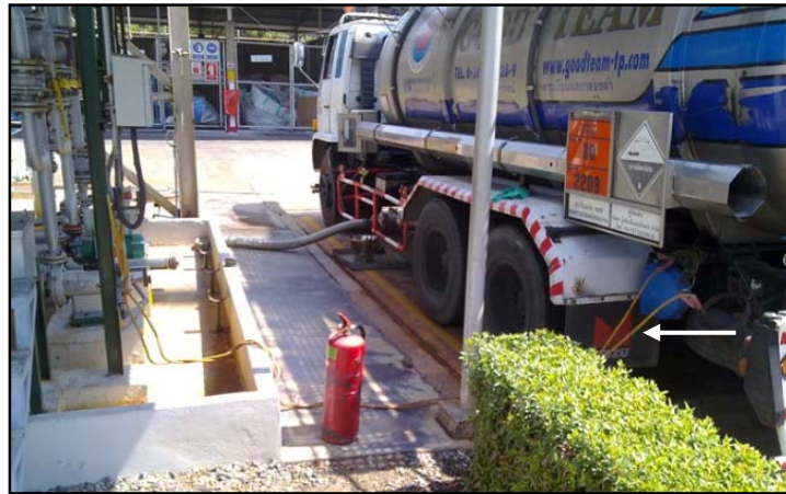
รูปที่ 5-2 ตัวอย่างการต่อสายดินและเตรียมอุปกรณ์ดับเพลิงขณะขนถ่ายฟอร์มัลดีไฮด์
