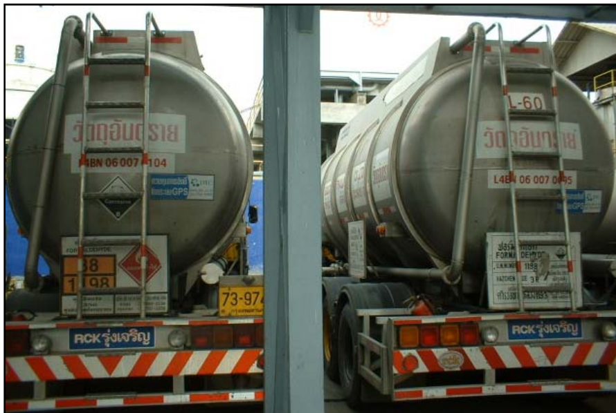
รูปที่ 3-8 ตัวอย่างรถแท็งก์สำหรับขนส่งฟอร์มาลีนพร้อมป้าย สัญลักษณ์ และรหัสแท็งก์ตามมาตรฐาน
