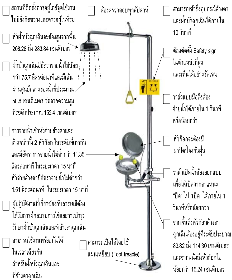
รูปที่ 7-1 ฝักบัวฉุกเฉินและที่ล้างตาฉุกเฉิน (Emergency shower and emergency eye wash)
