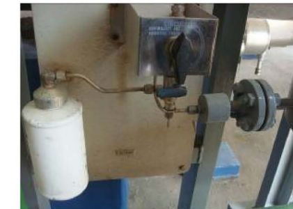
รูปที่ 7-1 การเก็บตัวอย่างเบนซีนในระบบปิด
