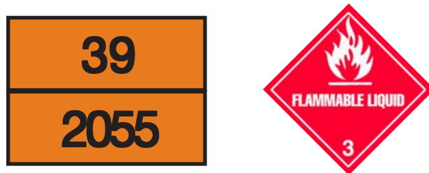
รูปที่ 6-1 ป้ายติดข้างรถขนส่งสำหรับสไตรีนโมโนเมอร์
