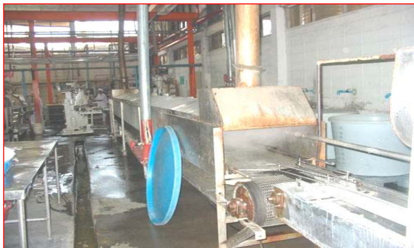
รูปที่ 3-4 ตู้ไล่อากาศ
