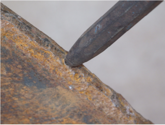
รอยเคาะ ตอก บริเวณแนวเชื่อม และความดันแอมโมเนียที่ถัง Receiver Tank (10 Bar)
