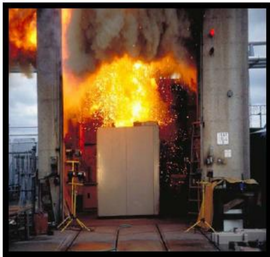
รูปที่ 2 รังสีความร้อน แสงจ้า และโลหะหลอมละลายที่เกิดจากอาร์ก
