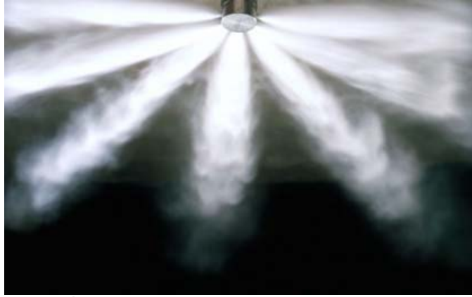
รูปที่ 4.8.2 แสดงการฉีดพ่นของสารสะอาดดับเพลิง
