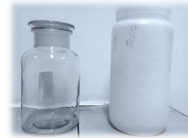
ตัวอย่างขวดพลาสติกและขวดแก้วที่ใช้ในการเก็บตัวอย่างน้ำเพื่อส่งวิเคราะห์
