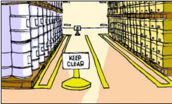
รูปที่ 4 พื้นอาคารต้องไม่ดูดซับของเหลว เรียบ ไม่ลื่น ไม่มีรอยแตกร้าว
