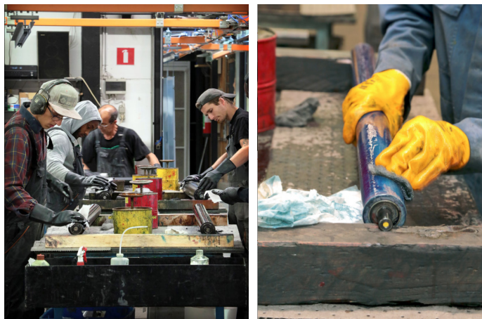
รูปที่ 2-17 การเช็ดทำความสะอาดลูกกลิ้งแม่พิมพ์โดยกดตัวทำละลายจากกระบอก Safety Plunger Cans (ที่มา: http://niceclean.be/nl )
