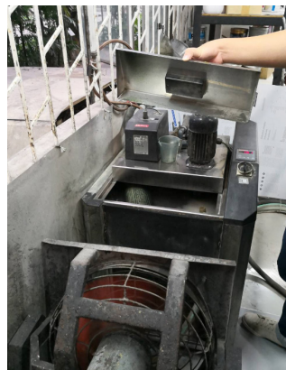
รูปที่ 2- 9 ตัวอย่างเครื่องทำความเย็นและหมุนเวียนน้ำยาฟาว์นเทน (Recirculation & Refrigeration Unit) ในระบบการพิมพ์แบบ off set (ที่มา: http://www.zfc-printing.com และ โรงพิมพ์แห่งจุฬาลงกรณ์มหาวิทยาลัย)
