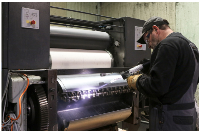
รูปที่ 2-25 การทำความสะอาดเครื่องพิมพ์ด้วย Dry Ice Blasting
