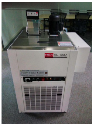
รูปที่ 2- 9 ตัวอย่างเครื่องทำความเย็นและหมุนเวียนน้ำยาฟาว์นเทน (Recirculation & Refrigeration Unit) ในระบบการพิมพ์แบบ off set (ที่มา: http://www.zfc-printing.com และ โรงพิมพ์แห่งจุฬาลงกรณ์มหาวิทยาลัย)
