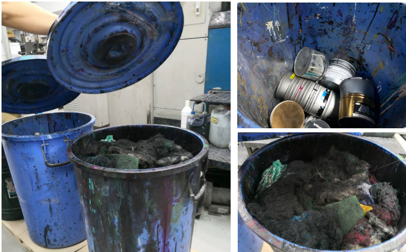
รูปที่ 2-19 ตัวอย่างภาพขณะจัดเก็บผ้ายูดที่ปนเปื้อนตัวทำละลายและหมึกพิมพ์ และการจัดเก็บกระป๋องหมึกพิมพ์ ที่ควรมีฝาปิดตลอดเวลา (ที่มา: โรงพิมพ์แห่งจุฬาลงกรณ์มหาวิทยาลัย)
