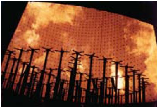
รูปที่ 2-2 ตัวอย่างลักษณะของการเผาไหม้ภายใน Enclosed Ground Flare
