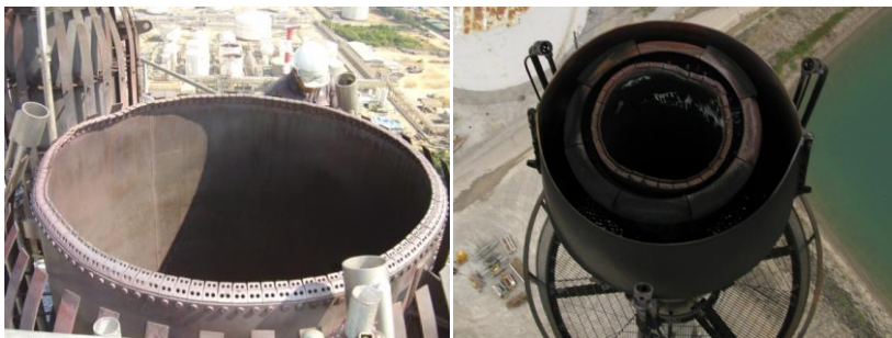
รูปที่ 2-23 ตัวอย่าง Flare Tip หรือ Burner Tip
