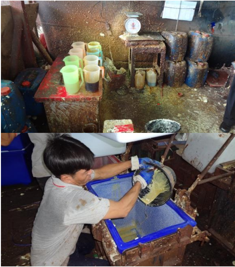
รูปภาพ ก-10 ด้านบนสภาพสถานที่ปฏิบัติงานการผสมด้วยวิธีการใช้มือ เครื่องเจียรไฟฟ้าแบบมือถือนำมาใช้ในการคน ก่อนนำไปเทใส่แบบ ด้านล่าง ผู้ปฏิบัติการใช้มือในการปาดโฟมที่ผสมเรียบร้อยแล้ว
