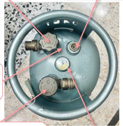
ลิ้นจ่าย พร้อมลิ้นควบคุมการไหล (Discharge Valve with Excess flow Valve)
