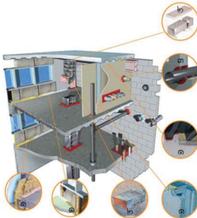
รูปที่ 3.2-37 ตัวอย่างช่องเปิดต่าง ๆ ภายในอาคารที่ต้องอุดปิดด้วยวัสดุป้องกันไฟลาม
